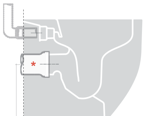
Scarico a parete predisposto - h. da 18 a 23 cm Wall discharge arrangement - h. from 18 to 23 cm
